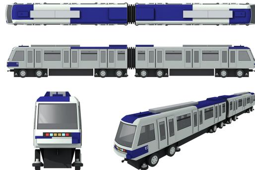
capacité de 222 passagers et pèsent 55 tonnes. Composées de deux automotrices, elles mesurent 30.68 mètres de longueur par 2.45 mètres de largeur. Afin de franchir les pentes importantes du tracé, elles roulent sur pneus et sont propulsées par un courant continu de 750 volts délivré par le rail de guidage.
