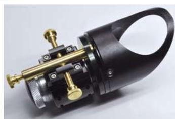
➤ LE MIROIR PRIMAIRE allégé est de forme conique et monté sur un barillet isostatique, il est indéréglable. LA COLLIMATION est réalisée en intervenant uniquement sur le miroir secondaire, dont les réglages ont été soigneusement repensés (à droite).
